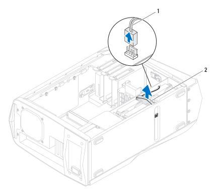
1 hard-drive fan cable 2 hard-drive fan assembly
